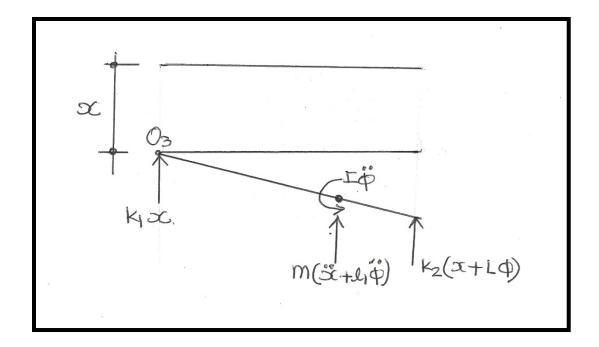
$$\begin{bmatrix} m & ml_1 \\ ml_1 & m \end{bmatrix} \begin{bmatrix} \ddot{x} \\ \ddot{\phi} \end{bmatrix} + \begin{bmatrix} k_1 + k_2 & k_2L \\ k_2L & k_2L^2 \end{bmatrix} \begin{bmatrix} x \\ \phi \end{bmatrix} = 0$$
